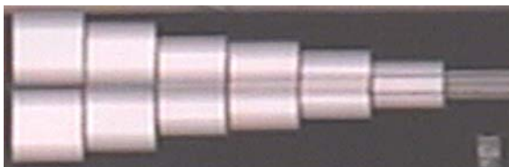
Рисунок 2 – Изображение штриховой миры при частоте вибрации 50 Гц
